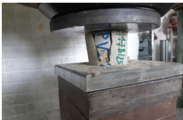
Pohled na porušený vzorek kamene PV2.1 při hodnotě krychelné pevnosti 72,6 MPa.
