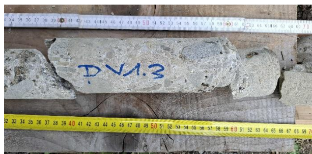
30-70 cm, následuje beton opěry, říční kamenivo netříděné, dobrý stav betonu.
