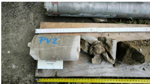
Pohled na strukturu 0-40 cm, pískovcový degradovaný kámen,
