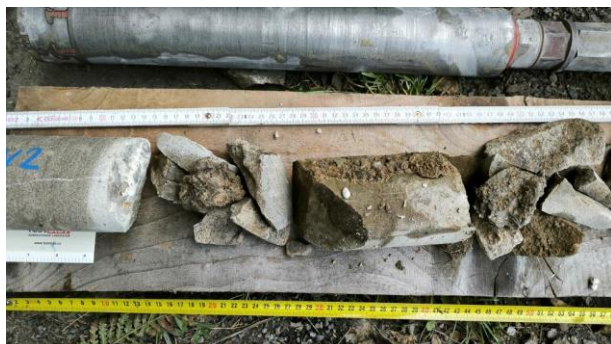
Pohled na strukturu 10-50 cm, pískovcový kámen, ložná malta nebyla detekována, byla vyplavena při jádrovém vrtání.
