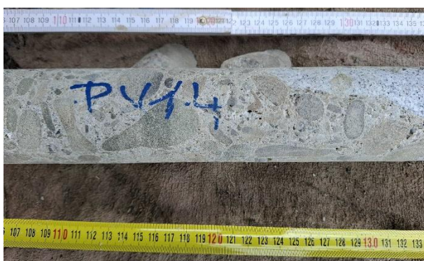
110-130 cm beton opěry se zvýšenou pórovitostí
