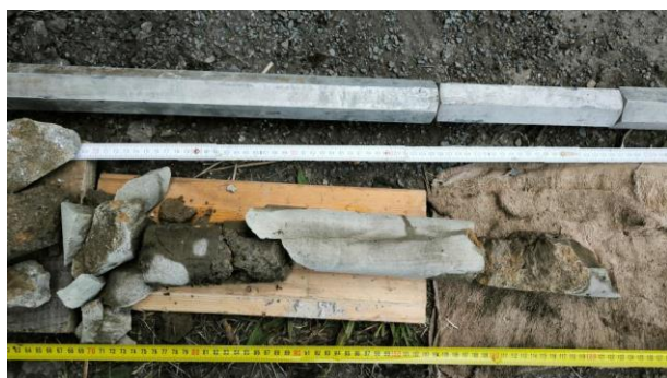
Pohled na strukturu 70-120 cm, pískovcový kámen, ložná malta nebyla detekována, byla vyplavena při jádrovém vrtání.
