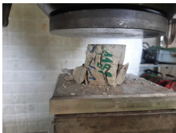
Pohled na porušený vzorek betonu opěry 1182/25 při hodnotě krychelné pevnosti 21,1 MPa.
