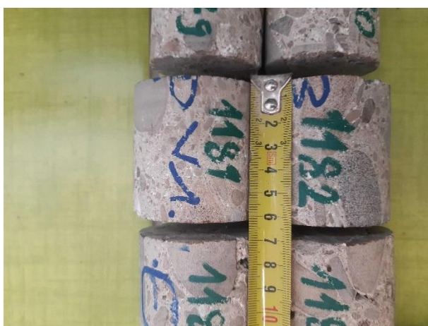
Detailní pohled na strukturu betonu. Kamenivo poměrně rovnoměrně rozloženo, cementový tmel bez pórů.
