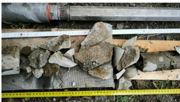
Pohled na strukturu 40-90 cm, pískovcový kámen, ložná malta nebyla detekována, byla vyplavena při jádrovém vrtání.
